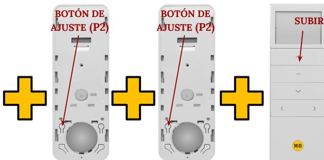
Pulse el botón de ajuste del motor (el motor pita)
